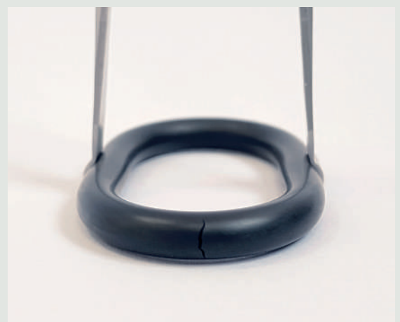
IL DIFETTO SI EVIDENZIA SOLAMENTE DOPO SCHIACCIAMENTO DEL PEZZO
